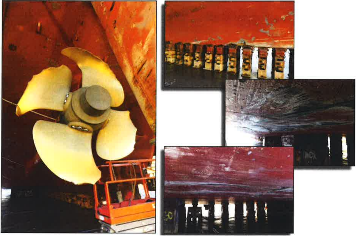
Resim 9 : Tekne ve pervane hasarı fotoğrafları.
