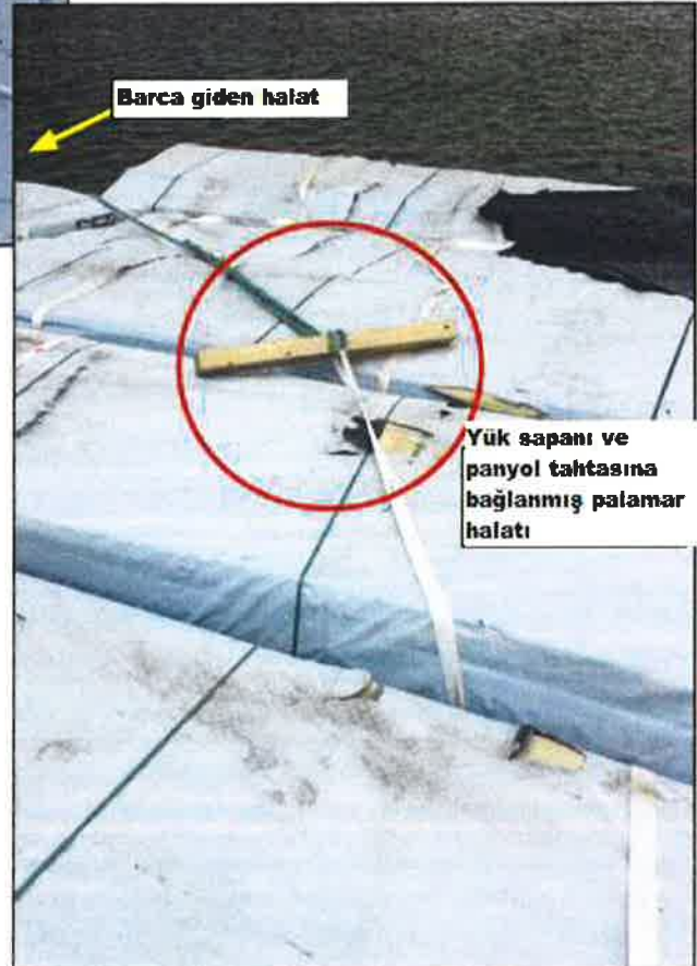
Resim 8 : Yük yığınına ilştirilmiş palamar halatı
