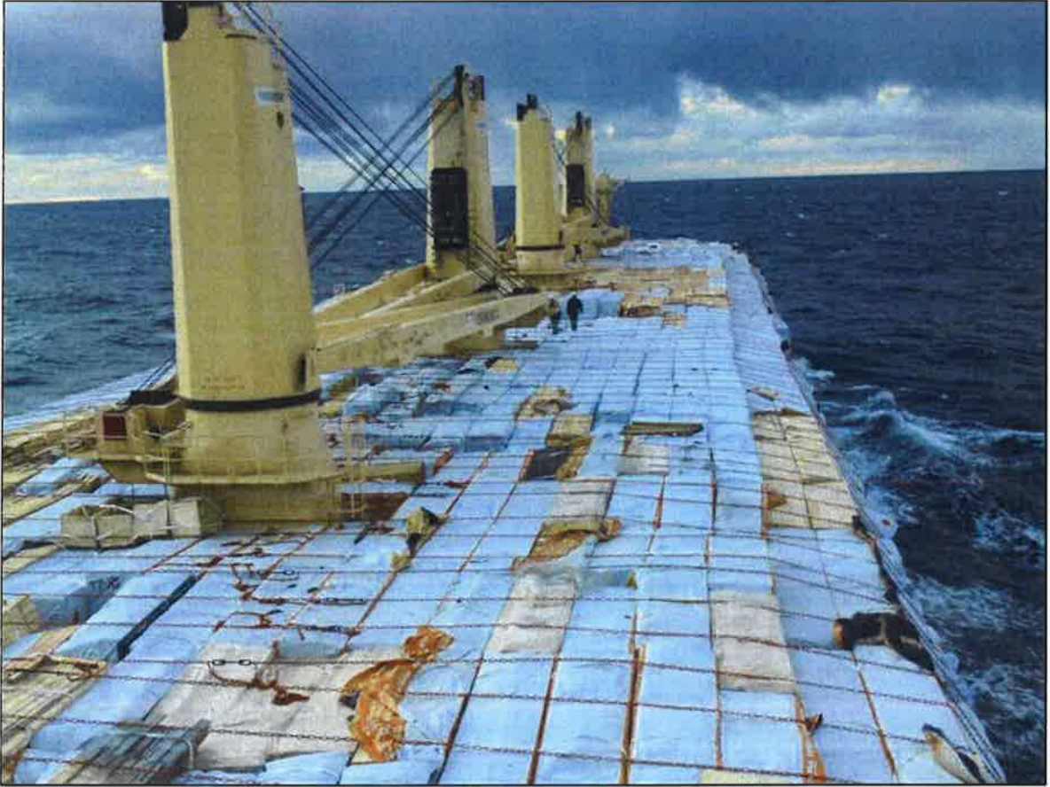
Resim 2: Graig Rotterdam gemisinin üzerinden bağlanmış güverte üstü kereste yükü ile seyirde.
