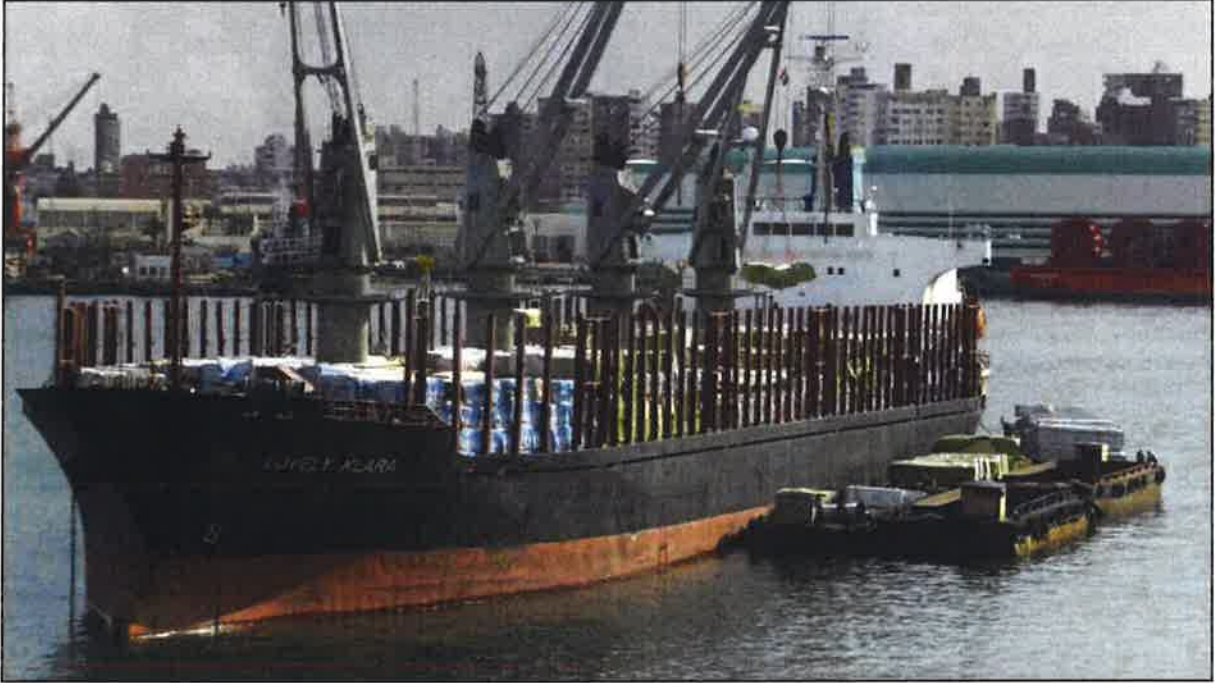
Resim 10 : Aynı demir sahasında paketli kereste yükü tahliyesi yapan, çelik babadalya donanımlı bir gemi.
